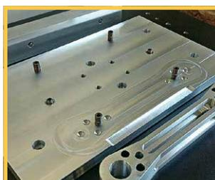
Unsere Pass- und Zentrierbolzen sind aus gehärtetem Einsatzstahl und äußerst präzise geschliffen. Die Keil- und Schwertformen gewährleisten genaues Zentrieren. Um möglichst einfache Elemente zu haben, werden alle Stifte mit M4 Innensechskant-Schrauben montiert. Dies erlaubt eine schnelle Entfernung, wenn die Stifte nicht benötigt oder ausgetauscht werden. Wenn man alle Vorrichtungen, Aufspannwürfel, Aufbauplatten usw. mit den gleichen Normteilen ausrüstet, verringert das die Rüstzeit.
